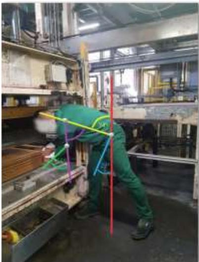
Figura 25 – Postura adotada pelo Trabalhador 4 (remoção da apara lateral)
